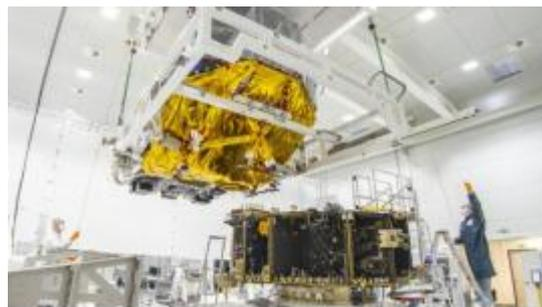
*Un momento dell'operazione di unione delle componenti di d. Plato, la parte su cui sono montate le fotocamere viene sollevata per sovrapporla al modulo di servizio*
