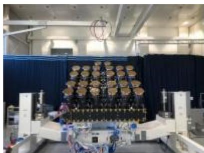
*Il modulo di carico (payload module) di Plato, con le 24 fotocamere standard disposte in quattro gruppi da sei, più le due ad alta velocità, visibili in cima*
